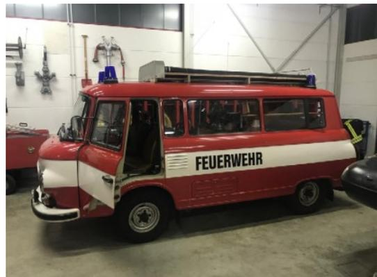
Das Fahrzeug ist derzeit nicht fahrbereit (Verdacht auf verschmutzte Abdichtung vor dem Motor). Die Rundumkennleuchten wurden ebenfalls abgebaut, befinden sich aber im Fahrzeug und lassen sich jederzeit wieder montieren. Sämtliche Funktechnik wird ausgebaut.
